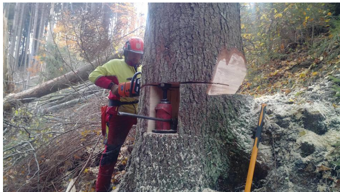
Obrázok 5 Použitie hydraulického klina pri smerovej stínke (foto J. Dudáš)
